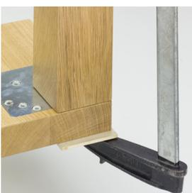
7. Die Tischfüße mit einer Schraubzwinde rechtwinklig fixieren. Entfernung der Schraubzwingen nach 6 - 8 Stunden – volle Aushärtung und Belastbarkeit nach 24 Stunden. Siehe Abbildung
