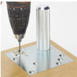
4. Zum Verschrauben der Tischfußbefestigungselemente an der Tischplatte müssen die Schraubenlöcher unbedingt auf eine Tiefe von 25 mm mit 3 mm Durchmesser vorgebohrt werden. Dadurch wird vermieden dass leichte Spannungsrisse an der oberen Seite der Tischplatte auftreten. Siehe Abbildung
